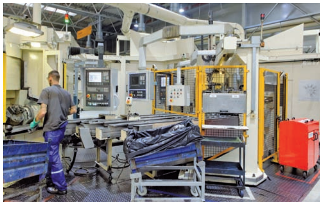
Obr. 4 Okrem hlavného obslužného panelu sú na obrábacích staniciach nainštalované aj lokálne obslužné panely. V prípade potreby to umožňuje použiť obrábacie stanice navzájom nezávisle.
