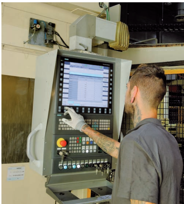
Obr. 3 Hlavný obslužný panel jedného z dvoch posledných modernizovaných strojov. Spínače s kľúčom blokujú všetky funkcie nastavovania a údržby, ktoré vyžadujú špeciálnu kvalifikáciu alebo bezpečnostné opatrenia.
