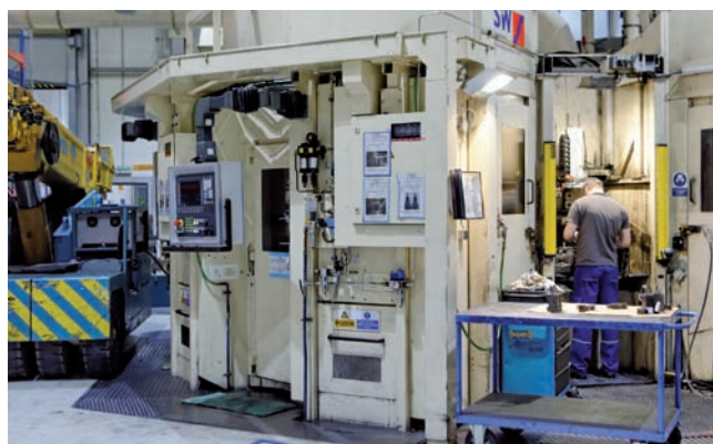
Obr. 2 Obrobky sa sústružia a frézujú prevažne na už použitých kruhových taktovacích obrábacích strojoch výrobcu Schwäbische Werkzeugmaschinen. Na obrázku je stroj, ktorý už spoločnosť Siemens vybavila novým riadiacim systémom.
