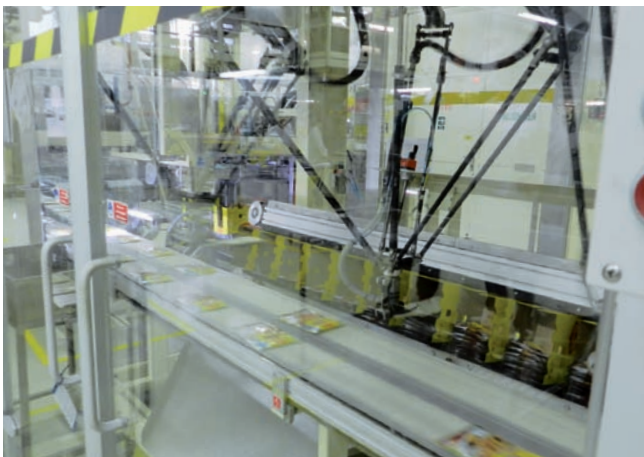
Ukladanie hotových výrobkov do kartónových škatúl na linke č. 19 majú na starosti delta roboty ABB.
