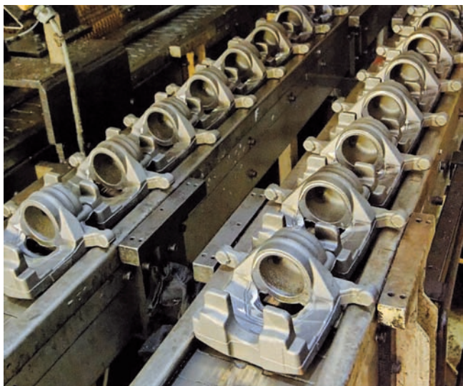
Obr. 1 Vysoká kvalita zaručuje vysokú bezpečnosť: Spoločnosť Continental vyrobí vo Zvolene ročne vyše deväť miliónov brzdových strmeňov.
